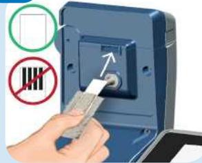
Tenez le capteur par l'emballage uniquement, avec la face blanche orientée vers le haut. Insérez-le jusqu'à ce qu'au fond de la fente.
