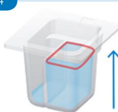
Remplissez la partie droite du réservoir jusqu'à la ligne. S'il vous reste de l'échantillon, versez-le dans la partie gauche du réservoir. Ne remplissez pas excessivement les réservoirs ou de l'eau giclera sur les contacts du capteur et faussera le test. Le test
