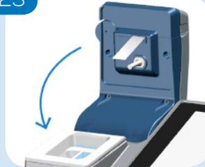
Retirez la feuille métallique du capteur. Fermez le bras. Le test démarrera automatiquement.
