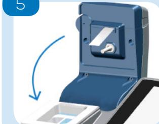
Retirez la feuille métallique du capteur. Fermez le bras. Le test démarrera automatiquement.
