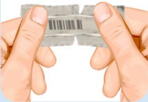
Déchirez chaque côté du paquet, puis tordez et déchirez le côté court du paquet, en révélant les pistes du capteur. Ne touchez pas la moitié dosée du capteur.
