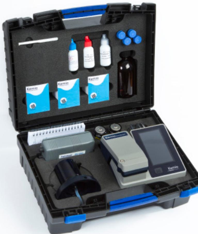
La méthode de test de chlorite implique trois mesures distinctes de différentes combinaisons chimiques dans l'échantillon, suivies de quelques calculs pour déterminer la concentration totale de chlorite. La procédure de test doit être soigneusement surveillée pour s'assurer du bon déroulement des réactions chimiques et des mesures.
