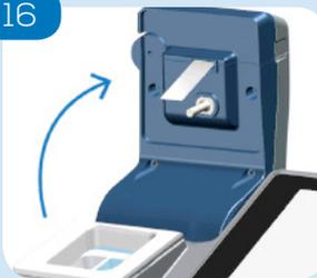
Ouvrez le bras et retirez le capteur. Conservez l'échantillon du test précédent.
