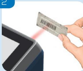
Scannez le code-barres du capteur. Tenez le code-barres à environ 12 cm de l'instrument. Alignez le point rouge avec le centre du code-barres. Une fois la lecture achevée, l'instrument passe à l'écran suivant.
