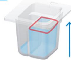
Remplissez la partie droite du réservoir jusqu'à la ligne. S'il vous reste de l'échantillon, versez-le dans la partie gauche du réservoir. Ne remplissez pas excessivement les réservoirs ou de l'eau giclera sur les contacts du capteur et faussera le test.
