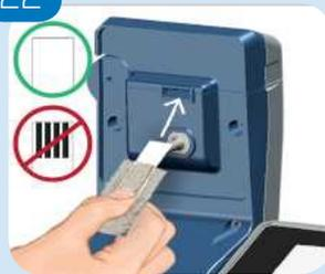
Tenez le dernier capteur CDX par l'emballage uniquement, avec la face blanche orientée vers le haut. Insérez-le jusqu'à ce qu'au fond de la fente.
