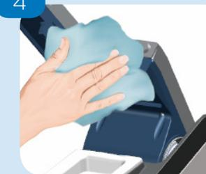
Si l'instrument est mouillé, essuyez-le avec un chiffon en suivant les indications de nettoyage et d'entretien. Faites très attention aux contacts électriques. Pour y accéder, ouvrez le couvercle avant du bras.
