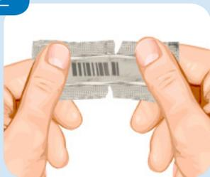
Déchirez chaque côté du paquet, puis tordez et déchirez le côté court du paquet, en révélant les pistes du capteur. Ne touchez pas la moitié dosée du capteur.
