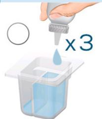
Si du chlore ou du cuivre est présent dans la solution, ajoutez 3 gouttes d'un réactif de glycine afin de prévenir toute interférence avec la mesure. Utilisez l'agitateur pour mélanger l'échantillon. En l'absence de chlore ou de cuivre, omettez cette étape.
