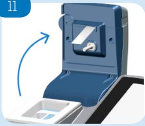
Pendant le dégazage, préparez le test suivant. Ouvrez le couvercle, retirez le capteur et éliminez l'ancien échantillon.
