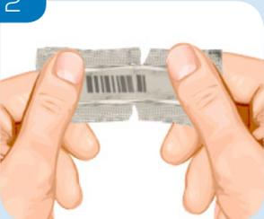
Déchirez chaque côté du paquet, puis tordez et déchirez le côté court du paquet, en révélant les pistes du capteur. Ne touchez pas la moitié dosée du capteur.
