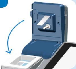
Retirez la feuille métallique du capteur. Fermez le bras. Le test démarrera automatiquement.
