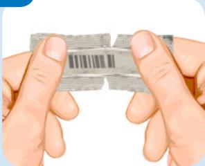
Déchirez chaque côté du paquet du capteur CDX, puis tordez et déchirez le côté court du paquet, en révélant les pistes du capteur. Ne touchez pas la moitié dosée du capteur. Tenez le capteur par l'emballage uniquement, avec la face blanche orientée vers le haut. Insérez-le jusqu'à ce qu'il soit au fond de la fente.
