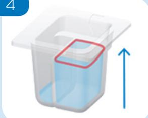
Remplissez la partie droite du réservoir jusqu'à la ligne. S'il vous reste de l'échantillon, versez-le dans la partie gauche du réservoir. Ne remplissez pas excessivement les réservoirs ou de l'eau giclera sur les contacts du capteur et faussera le test.
