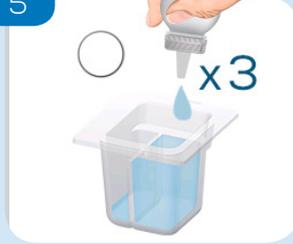
Si du chlore ou du cuivre est présent dans la solution, ajoutez 3 gouttes du réactif de glycine afin de prévenir toute interférence avec la mesure. Utilisez l'agitateur pour mélanger l'échantillon. En l'absence de chlore ou de cuivre, omettez cette étape.
