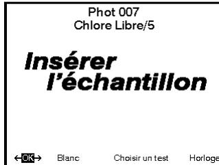
Insérer l'échantillon dans le support d'éprouvettes, et appuyer [OK].
